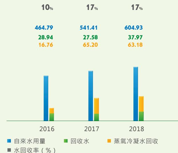
註：台中廠水回收率=台中廠回收水量+蒸氣冷凝水(脫礦水)回收量/台中廠自來水總用量
