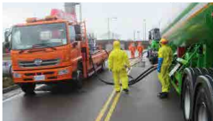
應變處理車協助洩漏車輛液氮移槽作業
